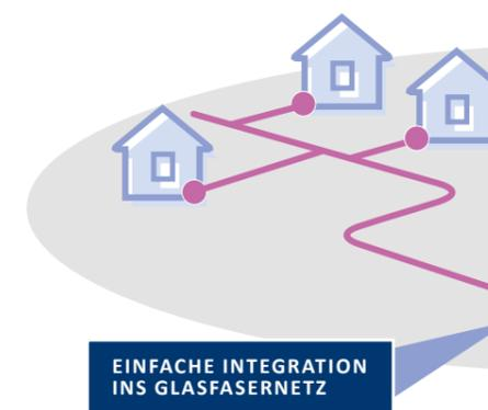
Die **Mitverlegung** dient zur Vorbereitung für einen späteren Ausbau. Ziel ist, möglichst viele Gebäude mit Leerrohren anzuschließen. Das Einblasen der Fasern findet erst im Zuge des Ausbaues statt.
